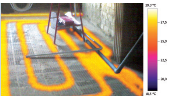
Verdeckte Rohrleitungen mit TwinPix auch im Echtbild erkennen
